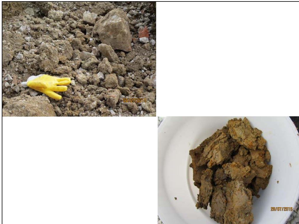
Bild 7: Material Schurf 2, Auffüllung(oben) und Boden (unten)
