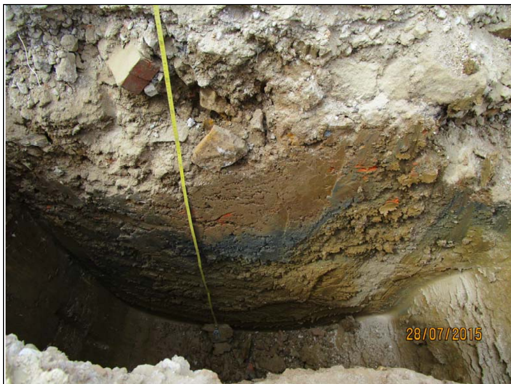
Bild 16: Schurf 7, Lehm bei ca. 1,2 m Tiefe dunkel verfärbt (organische Reste).
